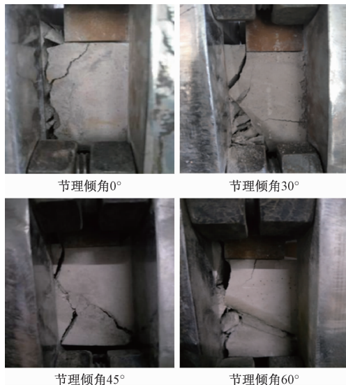
图 5 锚固贯通节理岩体破坏形态图
