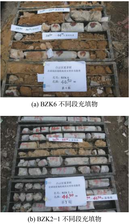
图 3 钻孔揭露岩溶发育特征
