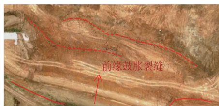
图 7 滑坡东侧前缘鼓胀裂缝
