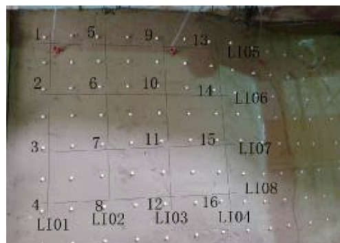
图7 红外热像仪检测区位置
