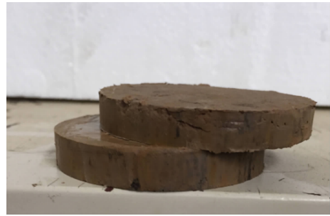
图 2 反复四次剪切的土样
