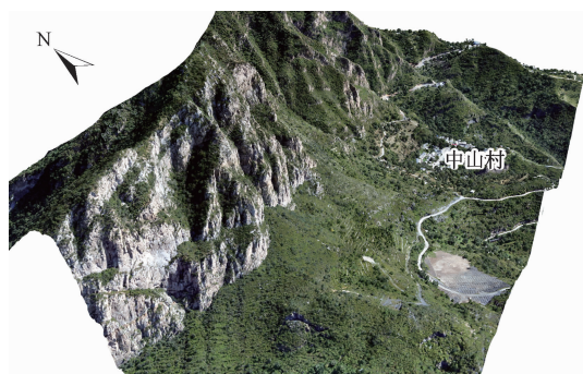
图 1 中山村崩塌隐患及其周边倾斜摄影三维实景模型 Fig.1 Real-time 3D model of the potential collapse site
