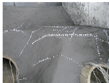
图 17 地震后模型围岩开裂情况
