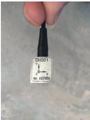
图 4 三向电容式加速度传感器
