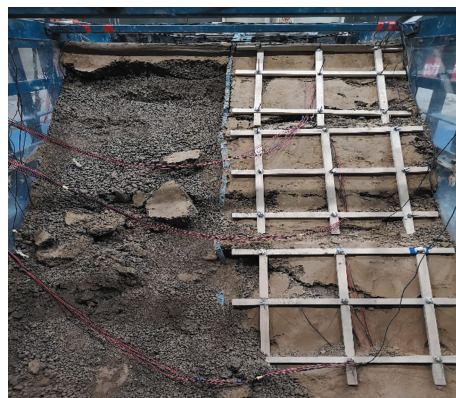
图 9 1.0g 时坡面破坏情况
