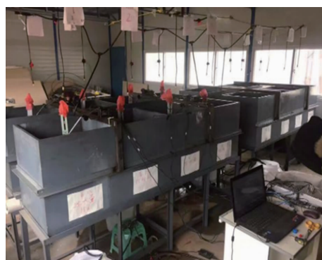
图 2 淋滤固结试验设备工作效果
