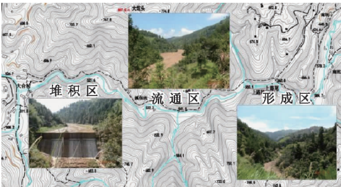
图 2 矿渣型泥石流空间分区示意图 Fig.2 Partition map of the slag debris flow
