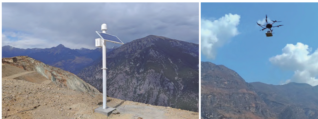
(d) 低功耗高精度多参数自适应北斗/GNSS监测终端和无人机部署抛投 [43]
